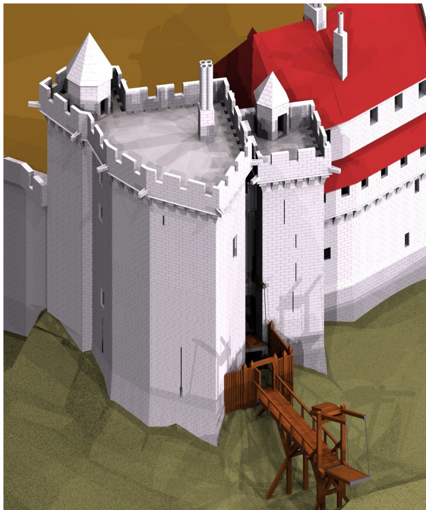
Figure 32 : Restitution de la Grosse tour et du dispositif d'accès à la porte Coquesart en 1410-12
